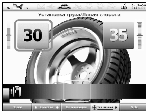
Рисунок 5.12 – Экран при установке груза линейкой
