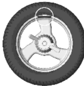
Рисунок 6.6 - Груз установлен в «12 часов»
