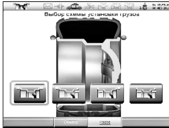
Рисунок 6.4 – Схемы установки грузов
