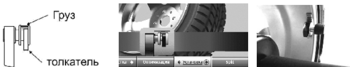
Рисунок 6.13 – Установка груза линейкой
